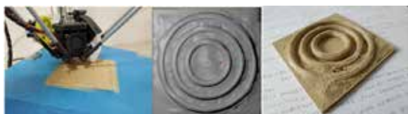
Proceso de modelado e impresión de prototipo de una de las piezas 3D
