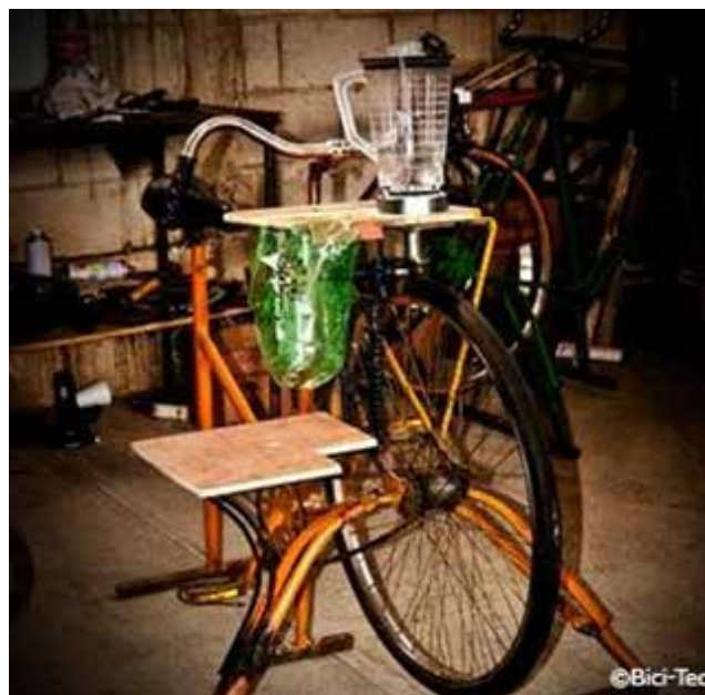
Figura 5: bicimáquina para triturar frutas. Fonte: Bici-Tec. Disponível em: https://meioseculodeaprendizagens.blogspot.com/2018/09/bicimaquinas-revoluca-do-pedal.html
